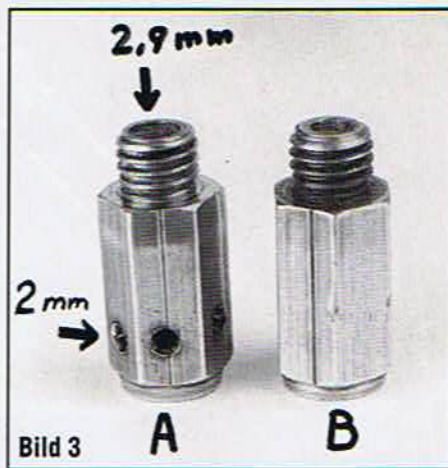
Bild 3 A) Modifierad. B) Original. Borra upp flottörventilen till 2,8 mm.
